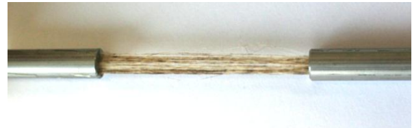
Fig. 2 : Epreuve de traction
