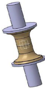
Figure 1 : Vue 3D de l'éprouvette conçue pour les essais de traction – torsion.
