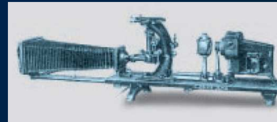
Microscope Métallographique Zeiss/Le Chatelier 1924 Première optique corrigée à l'infini
