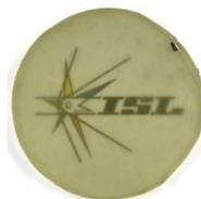
**Figure 1** : céramique transparente de YAG commercial obtenue par frittage SPS
