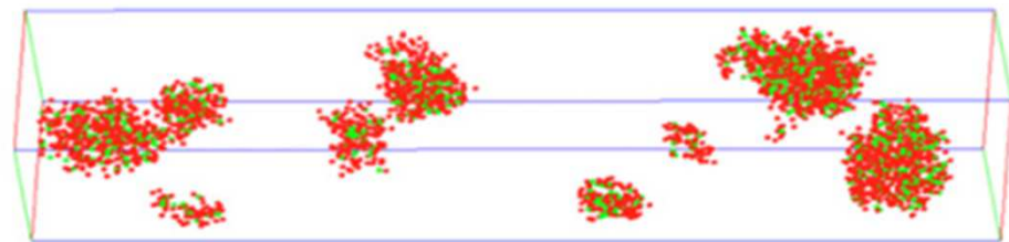
Al – Sc –Zr alloy, Al_3(Zr,Sc) E. Clouet & M. Nastar, CEA Saclay
