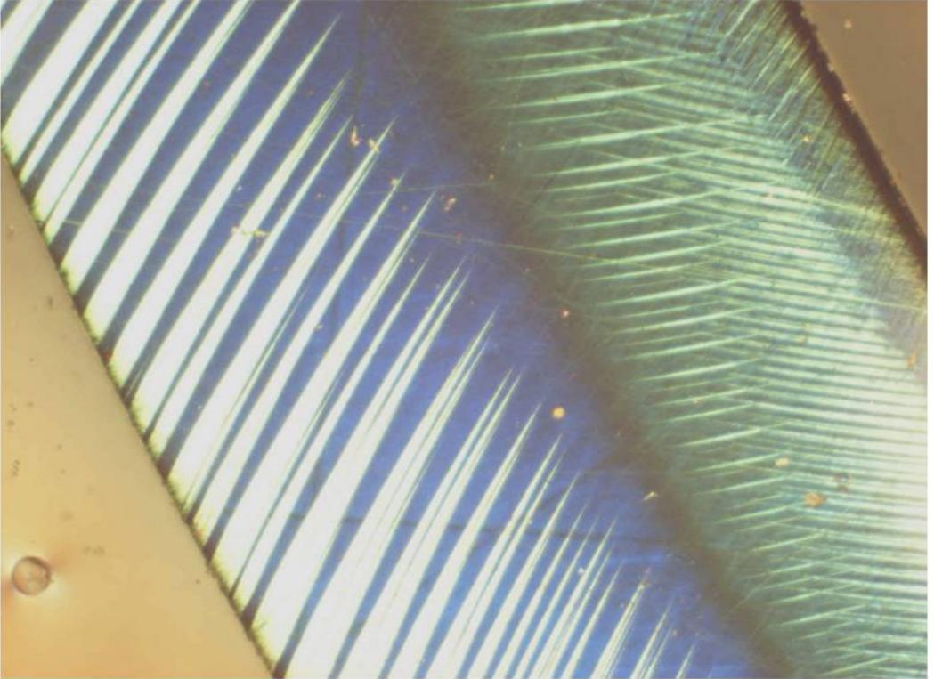
On observe parfaitement la fibre neutre, à l'intérieur du fil, ainsi que les côtés en traction et compression : les variantes de martensites activées sont différentes. Photo prise au microscope optique, en lumière polarisée.
